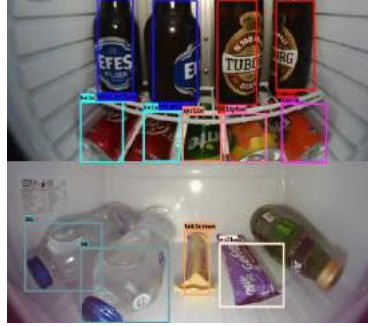
Şekil 4. Minibar içerisinde tanıma sistemi
