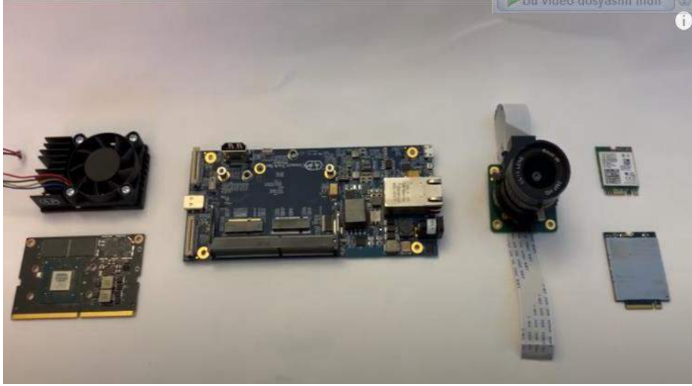
Şekil 3. Geliştirme kartı ve kamera[4].
